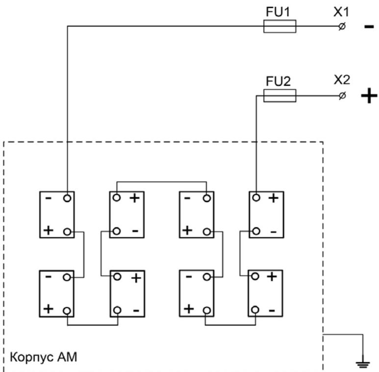
FU1,FU2 - Держатель предохранителя RT-18
